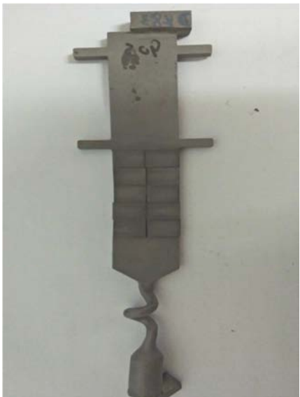
图2 螺旋选晶法制备的M4761单晶高温合金试板。
