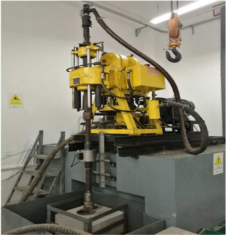
图4 XY-200型钻机外观图。
