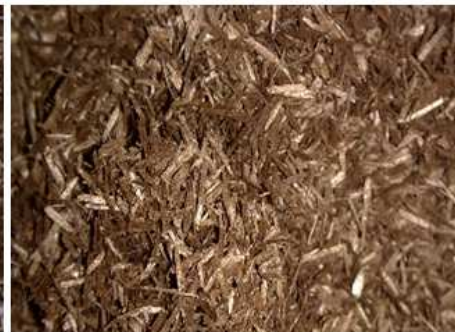
(d) Pretreated at 173°C, 7.5 bar, 45 min
